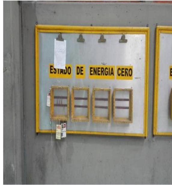
Mediante tarjetas de identificación de equipos involucrados en el zeslockout de bloqueo se logra tener una mejora significativa.
