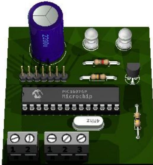
Figura 41. Vista en tercera dimensión de la tarjeta del control del aire acondicionado y la videocámara.
