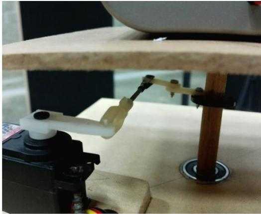
Figura 49. Servomotor y palanca
