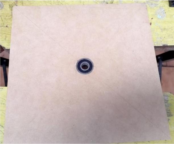
Figura 47. Base con rodamiento en el centro
