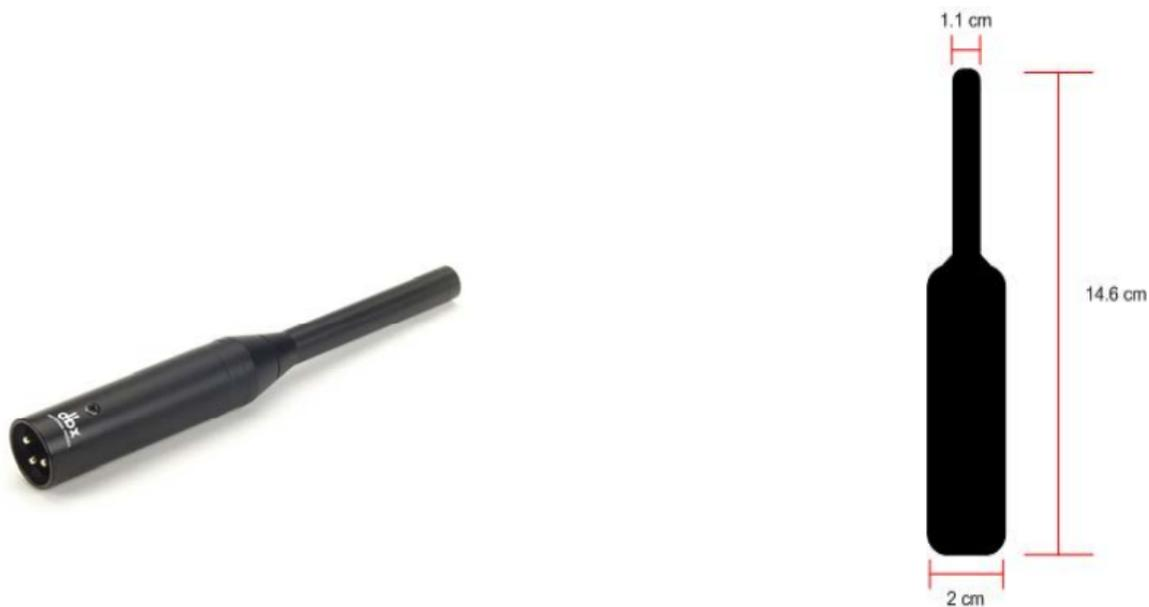
Figura 15. Dimensiones y vista real del micrófono de prueba dbx RTA-M
