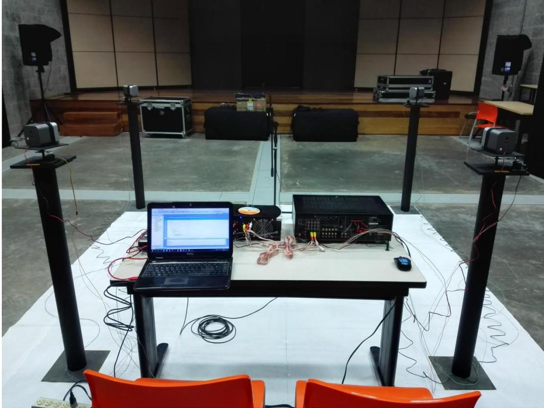
Figura 87. Conexión del sistema 5.1 al prototipo
