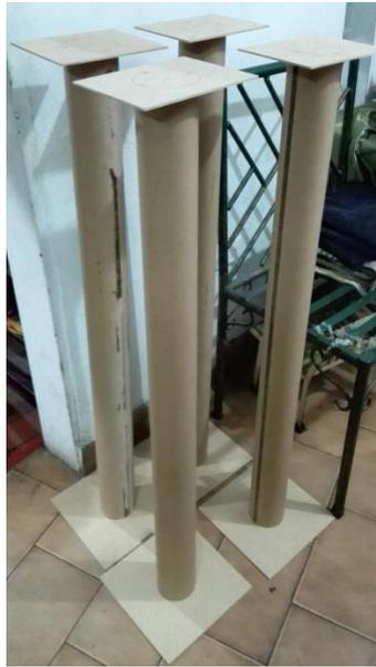
Figura 43. Soportes de Mdf para el pedestal
