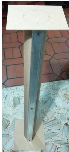
Figura 44. Canaleta de aluminio para parte frontal del pedestal
