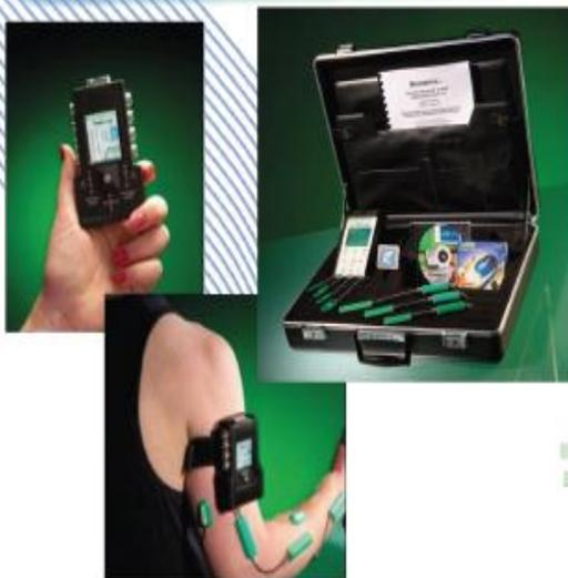
Dispositivo de recepción de los equipos de medición como goniómetros biplanares, torsiómetros, electro-miógrafos de superficie, dinamómetro, pinzómetro, miómetro, plataformas de fuerza y sensores de fuerza y de contacto; además de dispositivos digitales para la marcación de eventos o para el inicio remoto de la captura en el dispositivo.
