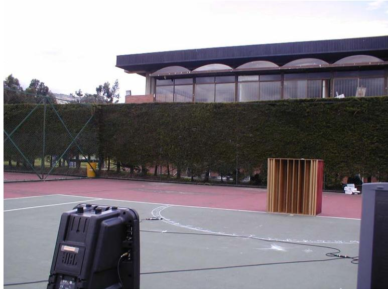
La fuente debe ser ubicada de frente a 0 grados y a -55 y 55 grados, con el fin de analizar el comportamiento del difusor cuando las ondas inciden de frente y aleatoriamente o por los lados. En total son 111 puntos de medición, que deben ser realizados, para lograr encontrar la respuesta difusa que será descrita finalmente en un plano polar.
