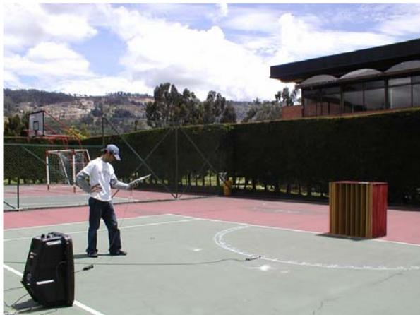
La norma establece las medidas para ubicar el micrófono receptor y la fuente frente a la muestra; el micrófono debe ser ubicado en un semicírculo con una resolución angular de 5 grados, por lo que es necesario realizar 37 puntos de medición desde -90 hasta 90 grados, estas medidas se deben realizar por cada nueva ubicación de la fuente.
