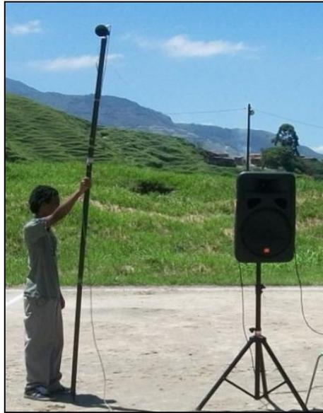
Figura B.10 Montaje tipo boom para la medición de la componente vertical
