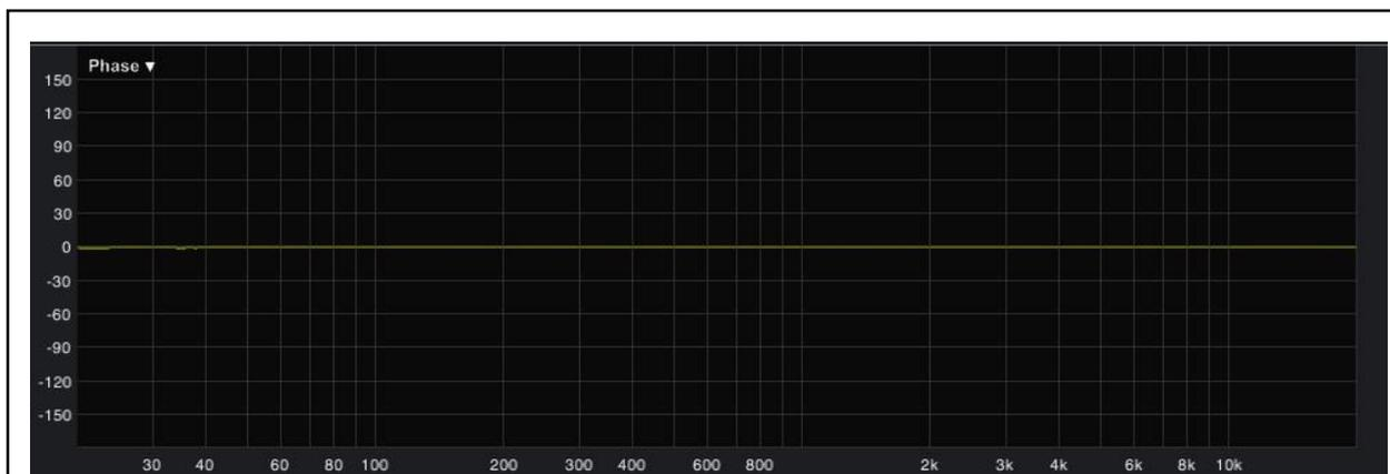
Fig. 14. Retraso de fase del ecualizador de fase lineal desarrollado para los canales izquierdo y derecho.
