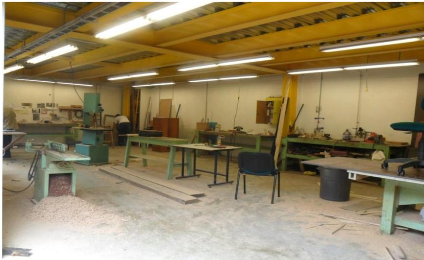
Realizando un estudio de las condiciones actuales del área de carpintería, se pudo identificar que entre las zonas de circulación y el área de trabajo, existen implementos de trabajo y materiales mal ubicados que impiden el flujo de personas y ponen en riesgo la seguridad. Como se observa en la figura 7, existen dos tablas de maderas ubicadas cerca de la zona de trabajo de la máquina sinfín que obstruyen la movilidad y aumentan la posibilidad de riesgo del trabajador. Con
