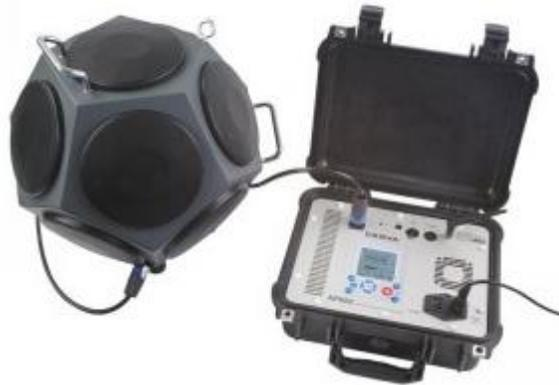
Fig. 34. Dodecaedro y fuente Cesva utilizado en la medición del tiempo de reverberación. [26].
