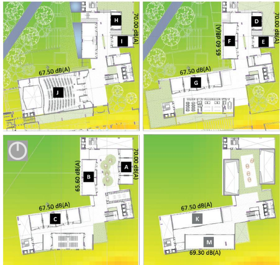
Figura 132, Relación del RF exterior en ponderación A con el espacio Interior
