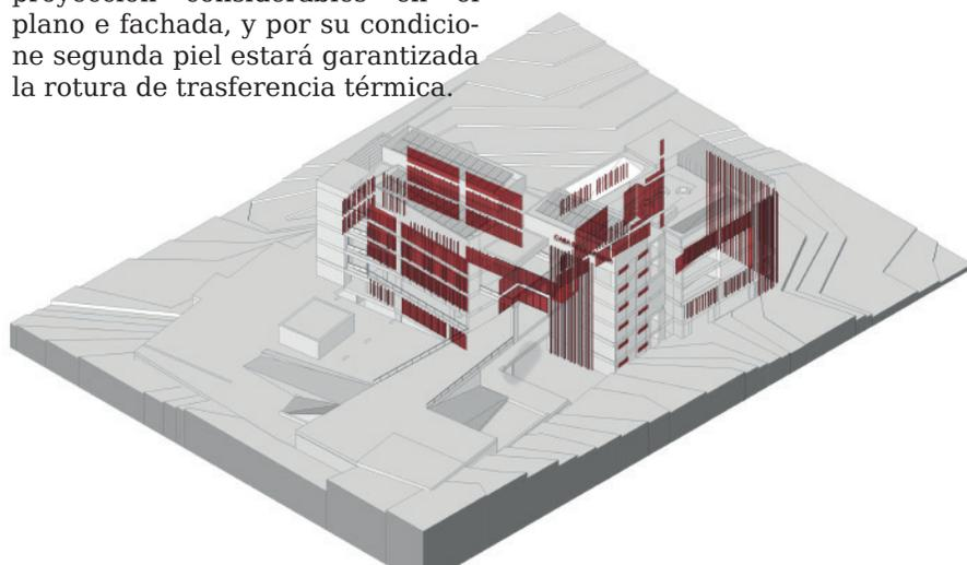
Figura 136, Estrategia de “PALITOS” Elementos de Protección Verticales
