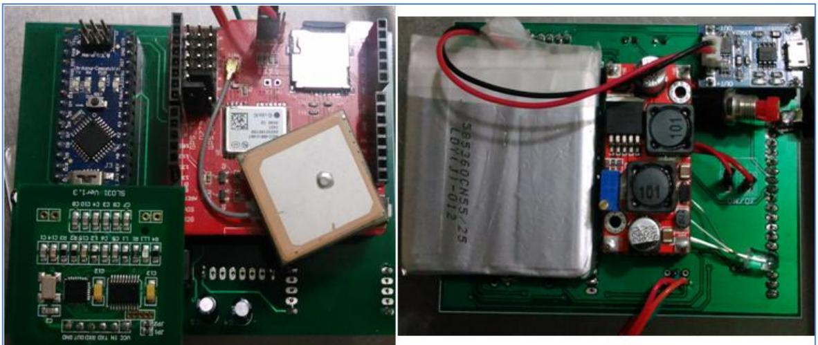
Figura 33. Montaje definitivo en PCB por ambas capas (imagen propia)
