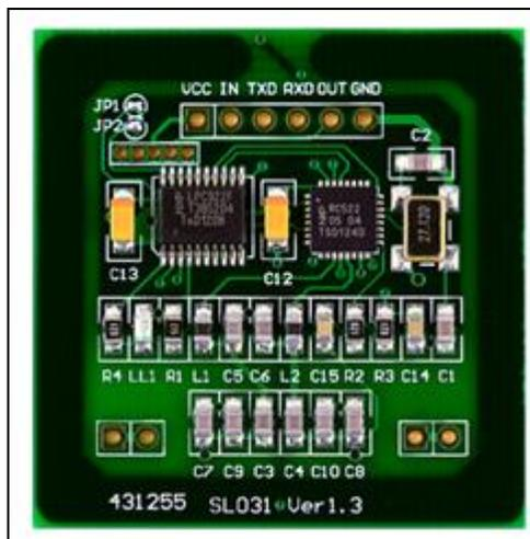
Figura 11. Módulo RFID SL031 (imagen propia)
