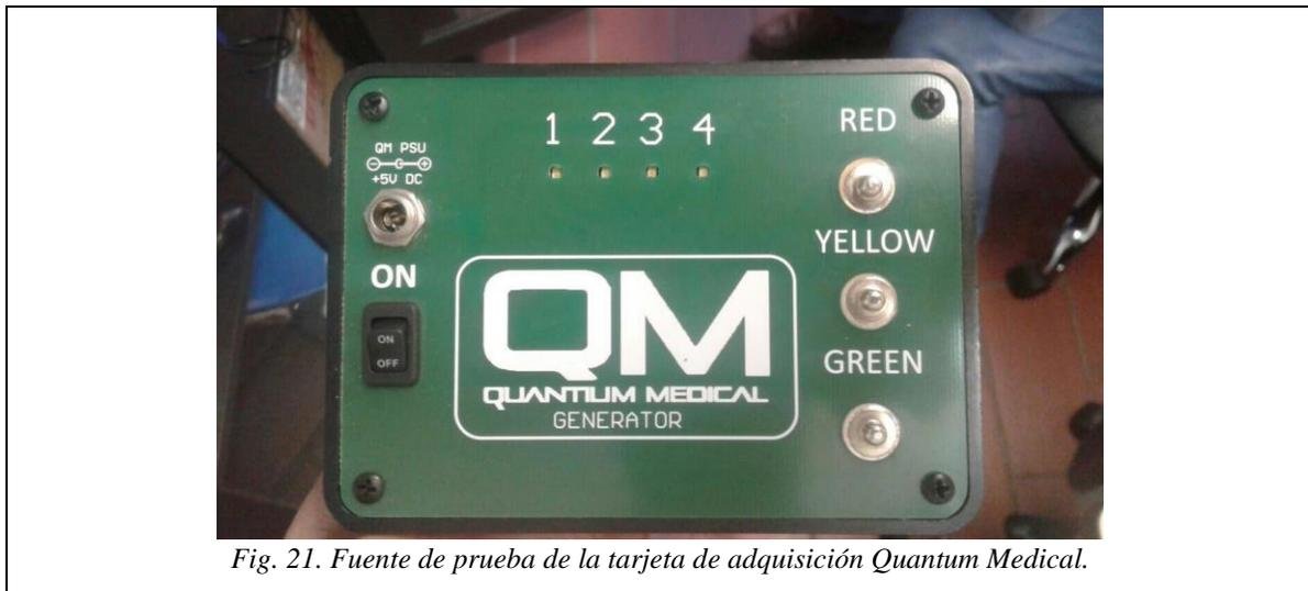
Fig. 21. Fuente de prueba de la tarjeta de adquisición Quantum Medical.
