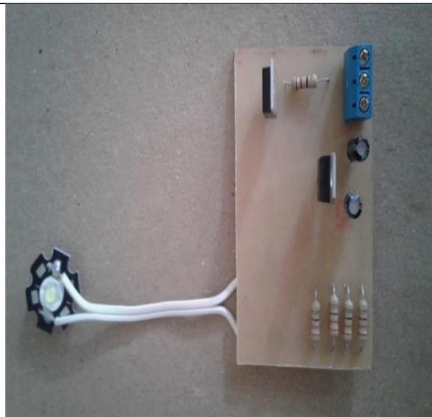
*Fig. 15. Montaje del led de potencia.*
