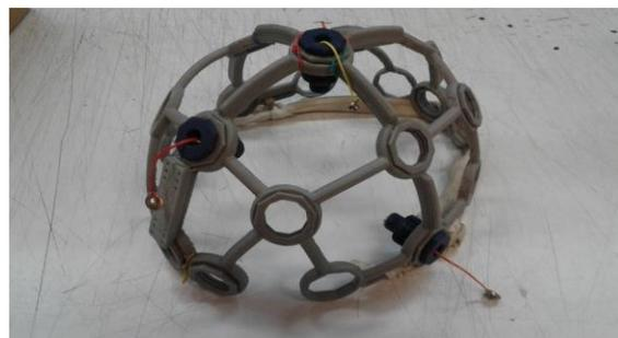
Figura 3: Dispositivo utilizado para ubicar los electrodos en las posiciones Pz, Cz y T4.
